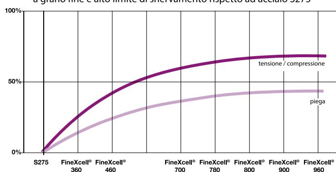
Il grafico a fianco mostra visivamente la riduzione di peso in percentuale ottenibile tramite acciai a grano fine ed alto limite di snervamento, ordinati in base al loro livello di resistenza e rapportati ad un acciaio convenzionale S275.
